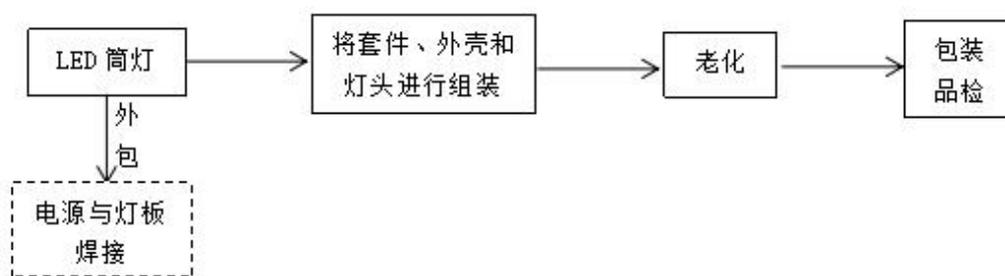
图 3.4 LED筒灯生产工艺流程及产排污环节图
