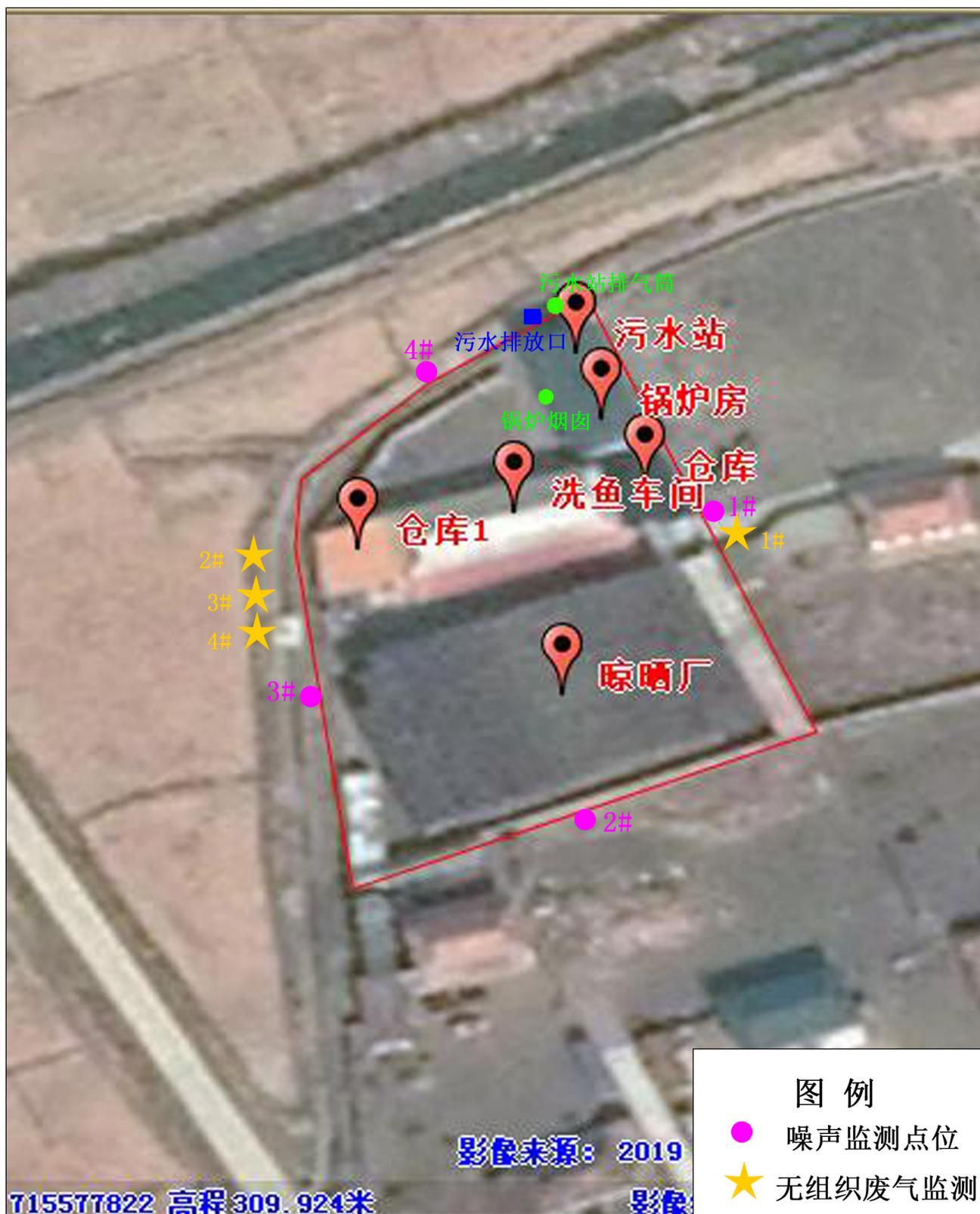
附图 2 平面布置及噪声监测布点图
