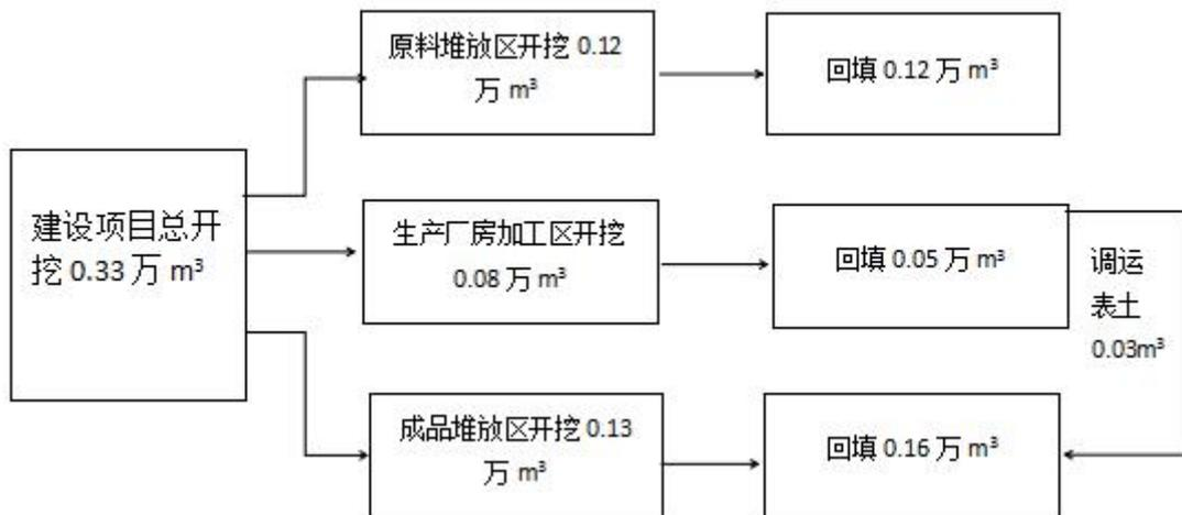
图 2-2 土石方流向图 (单位：m<sup>3</sup>)
