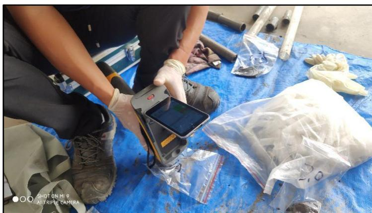
图 5-1 XRF 快筛设备
