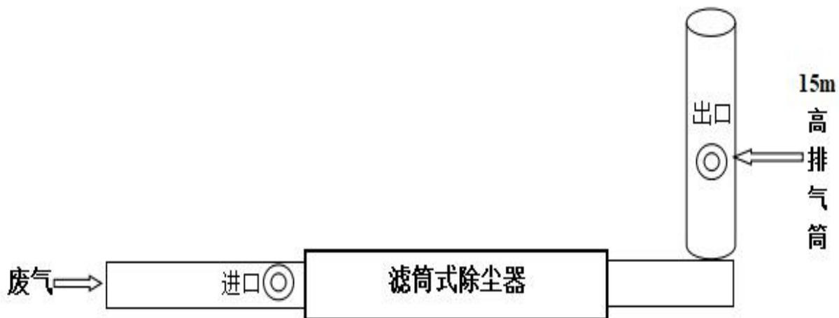
图 3-3 除尘设备采样点位示意图
