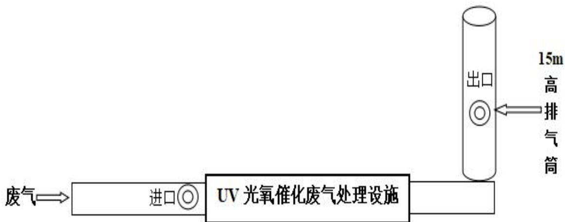
图 3-3 光氧处理设备采样点位示意图
