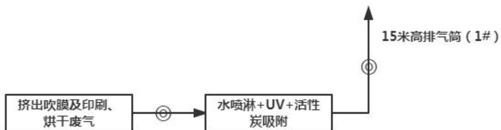
**图 3-1 印刷车间废气处理工艺流程图**
