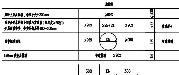
土路下污水管开挖及回填断面图
